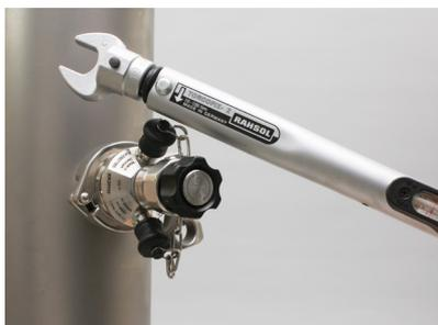
2 Instale a cabeça da válvula no corpo da válvula, girando a porca sextavada da cabeça no sentido horário e prenda-a com a barra tommy (# 900018) ou uma chave de torque com um **torque de 15 Nm**.
